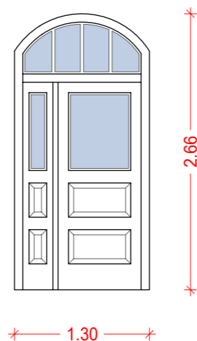
VV2 Dvokrilna vrata - dim. 160 x 260 cm 1 kos Pritličje - STRANSKI VHOD ( po opisu iz POPISOV DEL )
